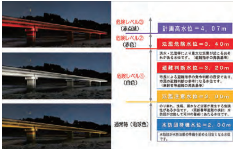
図4 基準水位による点灯イメージ
