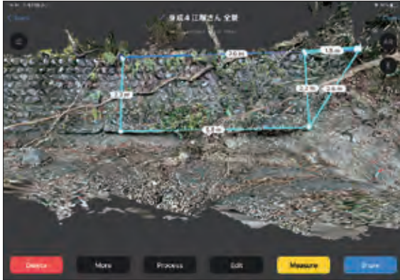
図2 モバイル端末による3次元計測の取組み
