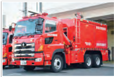
海水利用型消防水利システム (スーパーポンパー)
