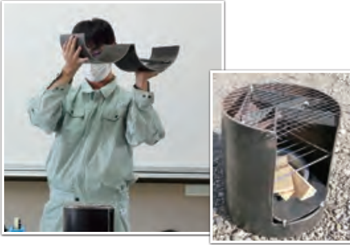
和歌山工業高校との交流で製作した内蔵型のかまど 「かまどすつーる」
