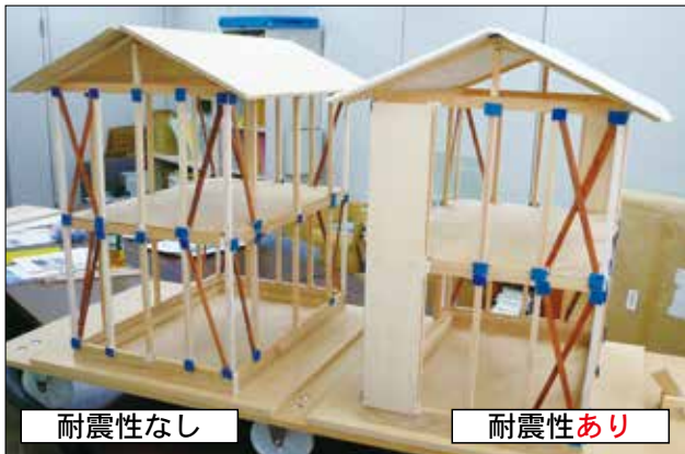
木造住宅の倒壊実験教材「ぶるる」
