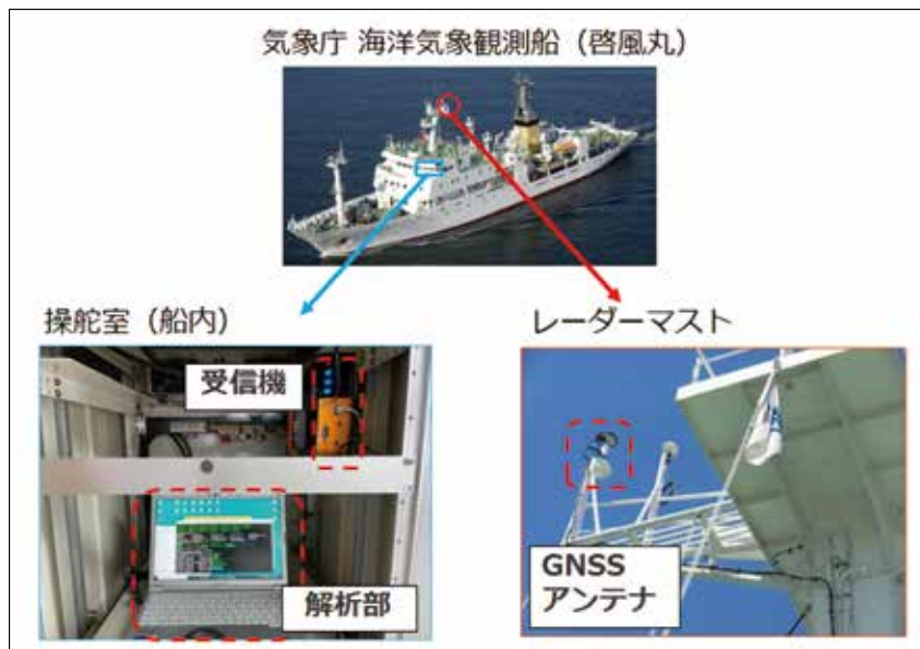
図1 GNSS観測機器
